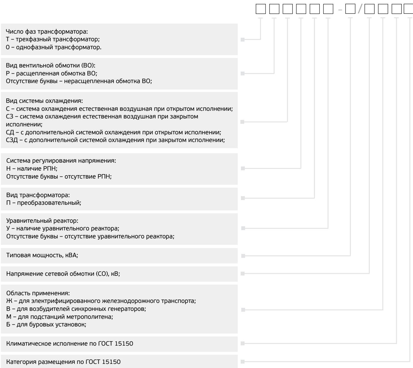
Пример условного обозначения трансформатора:
