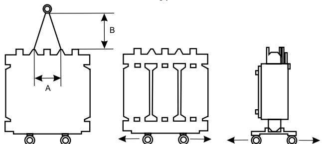
Трансформаторы оснащены ходовыми колесами, которые поворачиваются в двух направлениях. Для волочения можно использовать специальные проушины, расположенные около колес. Если трансформатор не оснащен поддоном, подъем на электрокар может быть осуществлен только в продольном направлении.
