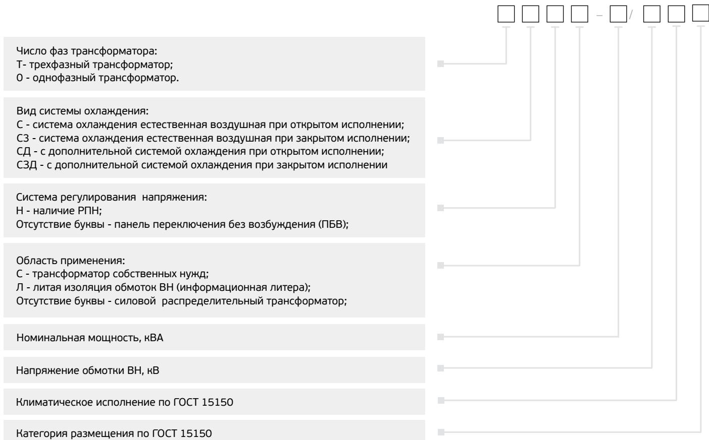
Пример условного обозначения трансформатора:
