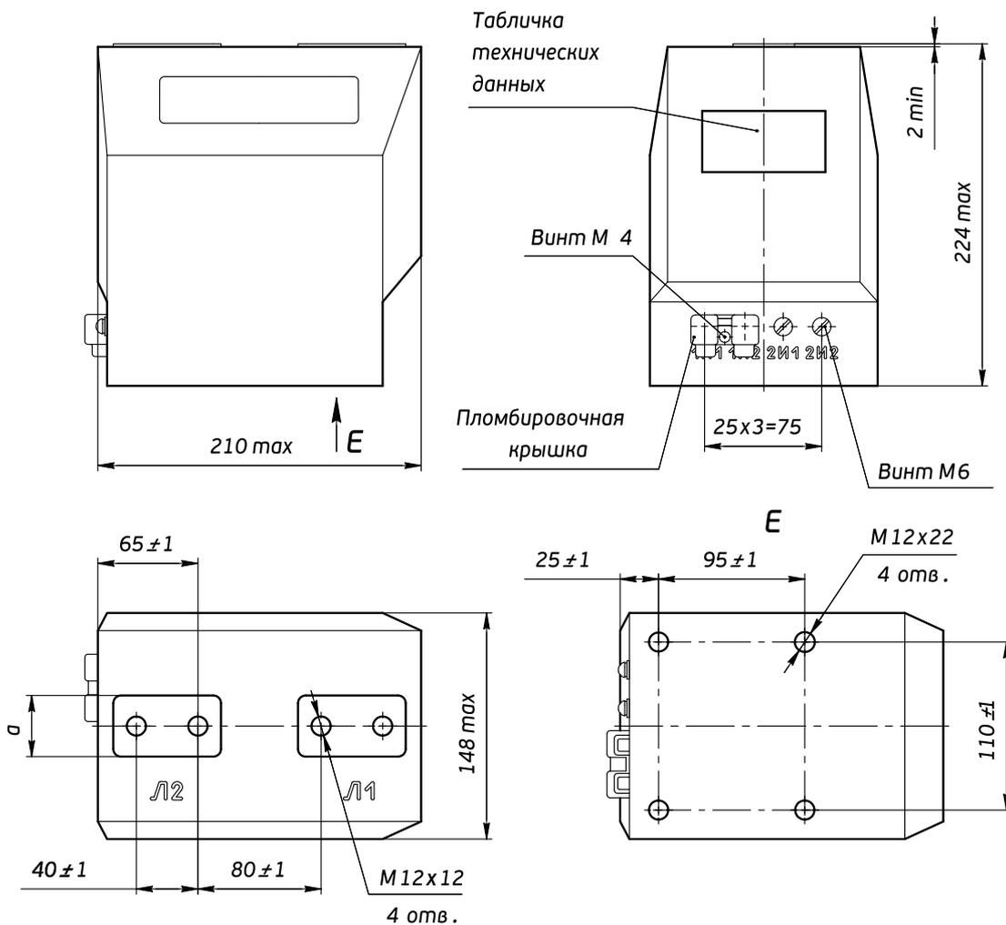
Рис . 1 - Общий вид трансформаторов ТОЛ-СВЭЛ-10М-29
