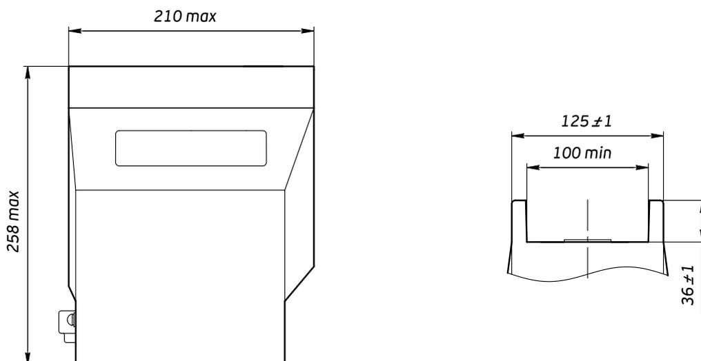
Рис . 2 - Общий вид трансформаторов ТОЛ-СВЭЛ-10М-29.1
